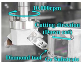
図9 フライカットによるゲルマニウム・グリズムの加工 (左)、MIMIZUKU 用グリズムの外観 (中央)、シリコンおよびゲルマニウムグリズムの回折効率 (右)。
