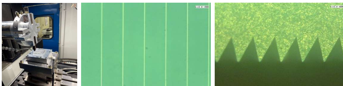
図2 RFT grating の切削加工 (左)、格子の顕微鏡写真：真上 (中央)、断面 (右)。
