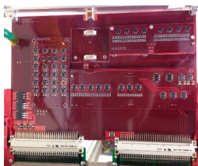
(左) ドライバボードの概観。左にバイアス電圧・バイアス電流生成ドーターボード、右下に出力スイッチ・クロックレベルシフタードーターボード、右上に出力監視用ADCボードが見える。(右) ADCボードの概観。4枚の4chプリアンプドーターボードと4枚の4ch ADCドーターボードが見える。
