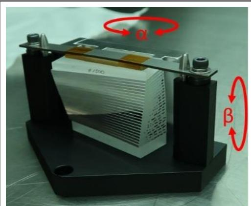
図1 FOCAS IFUのイメージスライサー。23個のスライスマイラーが少しづつ角度を変えながら積み重ねられている。
