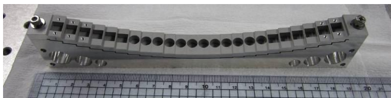
図 2.6 瞳ミラーホルダー試作品。四角い穴には軸外し楕円面ミラーが、丸い穴には球面ミラーが収納される。
