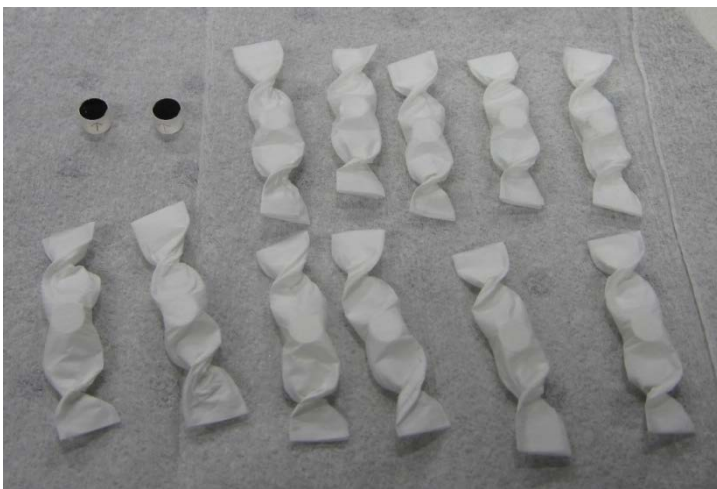
図3 瞳ミラー（球面） 23個の瞳ミラーのうち、11 個は球面ミラーを用いる。左 の写真は予備を含めた13個 の球面瞳ミラーである。 残り12個は軸外し楕円面で あり、その基板は納品されて いる。本年度、反射コーティ ングを施す予定である。
