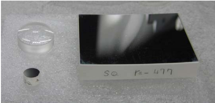
図2 拡大光学系光学素子 左上：ダブルレットレンズ 左下：折り曲げ用平面ミラー 右：凹面ミラー 全て納品済み。
