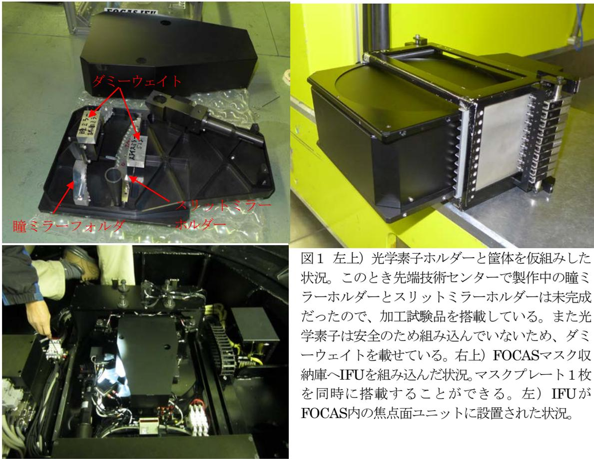
図1 左上) 光学素子ホルダーと筐体を仮組みした状況。このとき先端技術センターで製作中の瞳ミラーホルダーとスリットミラーホルダーは未完成だったので、加工試験品を搭載している。また光学素子は安全のため組み込んでいないため、ダミーウェイトを載せている。右上) FOCASマスク収納庫へIFUを組み込んだ状況。マスクプレート1枚を同時に搭載することができる。左) IFUがFOCAS内の焦点面ユニットに設置された状況。
