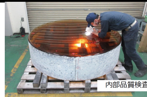
鏡材製造炉 再検証のため の試作 (オハラ)
