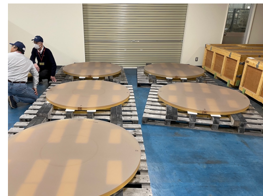
検証用に試作された主鏡分割鏡
