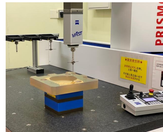
外形加工の試作：小サンプルによる裏面加工とその測定
